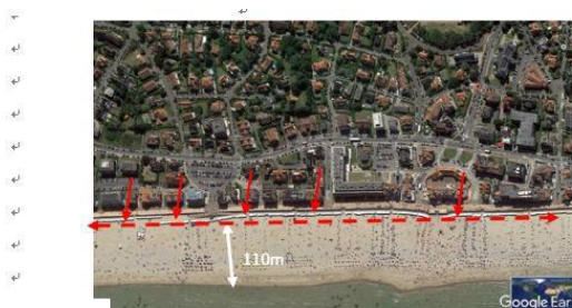
写真3 ベルギー・ウエンドウイネ海岸の防護ライン: 砂浜110m幅 + エスプラナド12m幅 + 市街地 : 街路 → エスプラナド ← 写真出典: Google Earth
